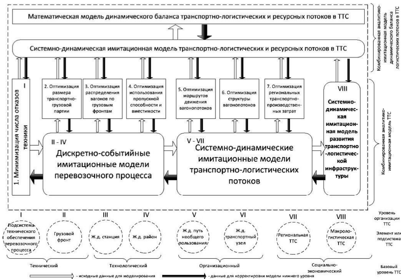
Рис. 2. Схема взаимосвязи блоков комбинированной аналитико-имитационной модели ТТС
