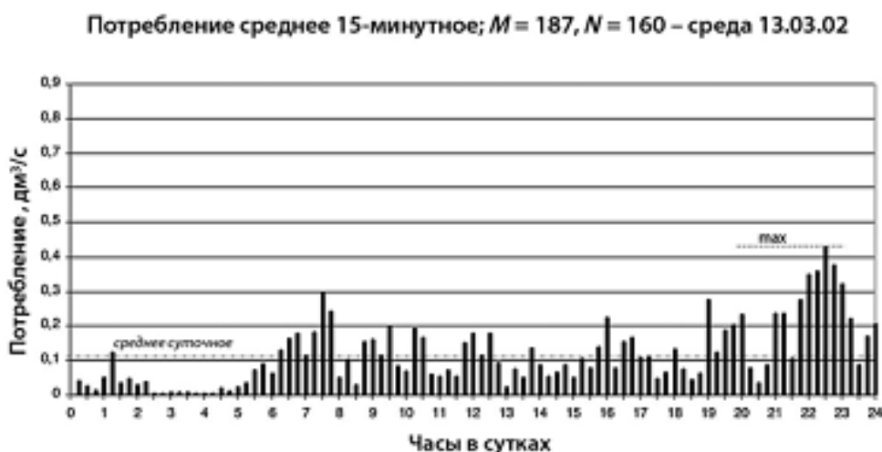
Рис. 6. Гистограмма среднего 15-минутного потребления воды в будний день жилым зданием (данные, полученные на основании эксперимента [2])
