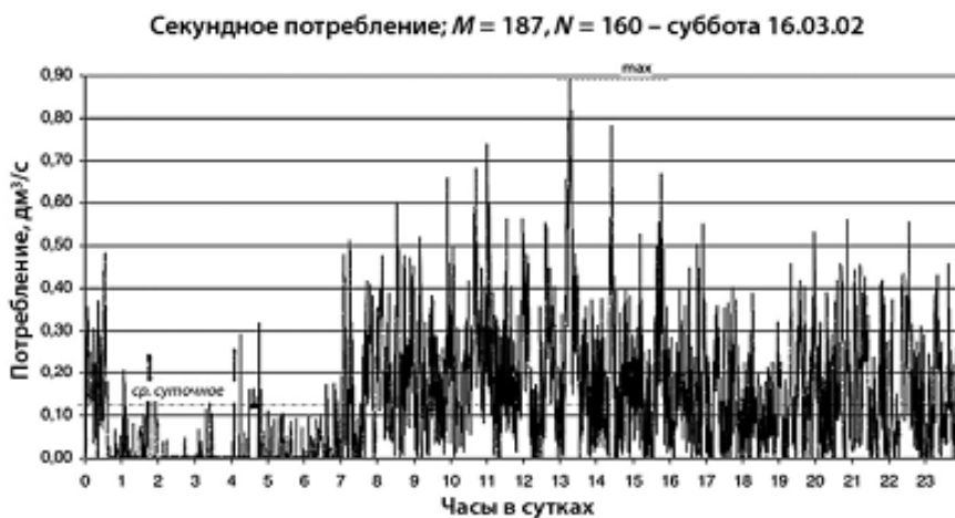
Рис. 4. Секундное потребление воды в выходной день жилым зданием (данные, полученные на основании эксперимента [2])
