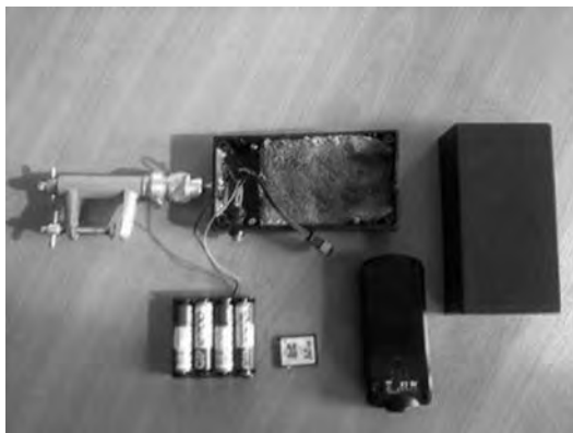
Рис. 2.4. Мобильная автономная камера видеонаблюдения
