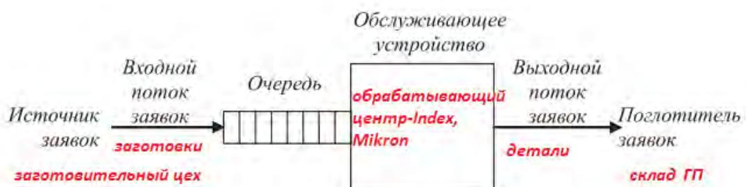
Рисунок 4 – Структура систем массового обслуживания
