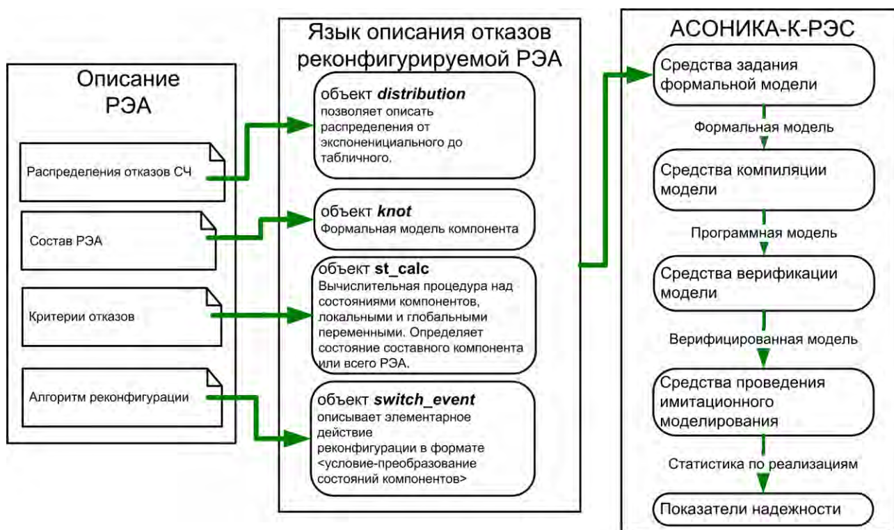
Рисунок 4 – Схема автоматизированного метода расчетной оценки показателей безотказности РЭА
