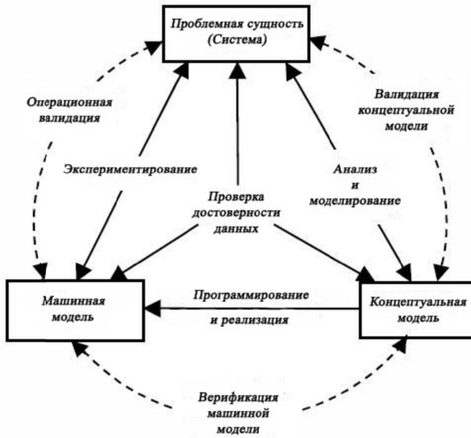
Рис. 1.4. Упрощенная схема процесса математического моделирования
