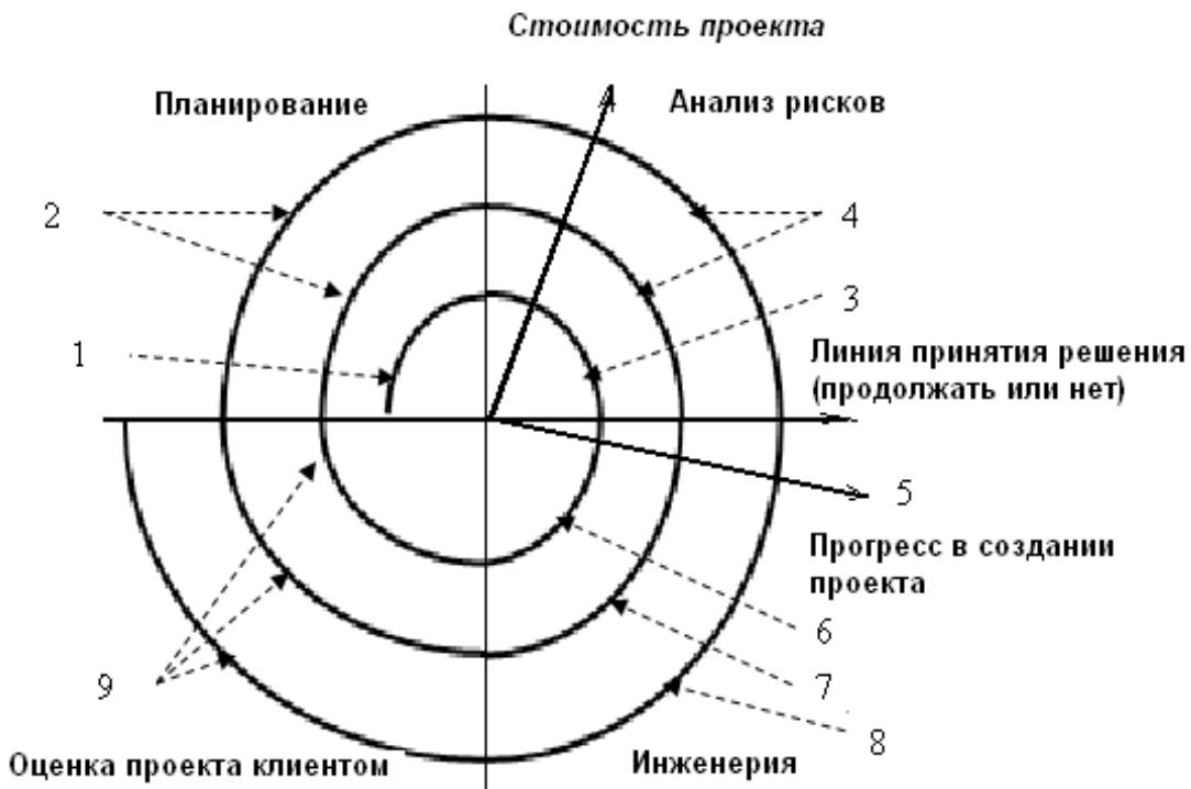
Рис. 1.5. Спиральная модель: 1 – начальный сбор требований и планирование проекта; 2 – та же работа, но на основе рекомендаций заказчика; 3 – анализ риска на основе начальных требований; 4 – анализ риска на основе реакции заказчика; 5 – переход к комплексной системе; 6 – начальный макет системы; 7 – следующий уровень макета; 8 – сконструированная система; 9 – оценивание проекта заказчиком
