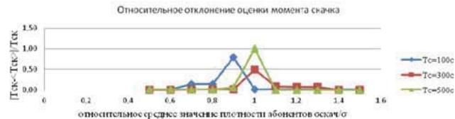
**Рис. 4.** Относительное отклонение оценки момента скачка входящего потока при различных значениях относительной плотности абонентов
