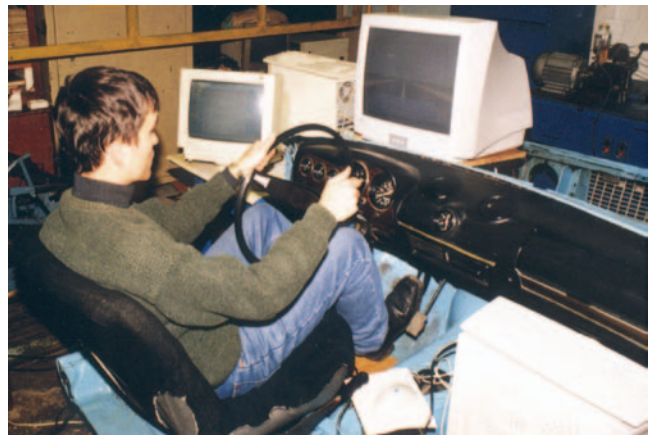
Рисунок 1. Имитационный стенд-тренажер для испытания автоматизированных тормозных систем автомобилей (ВолГТУ)
