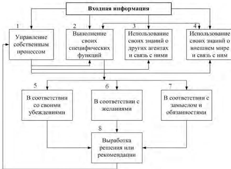
Рис. 2. Схема функционирования агента системы управления
