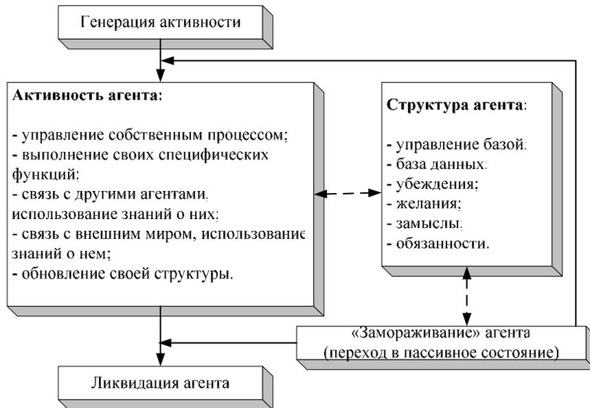
Рис. 1. Структурная схема агента системы управления
