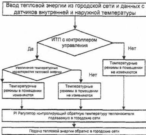
Рис. 6. Блок-схема управления моделью
