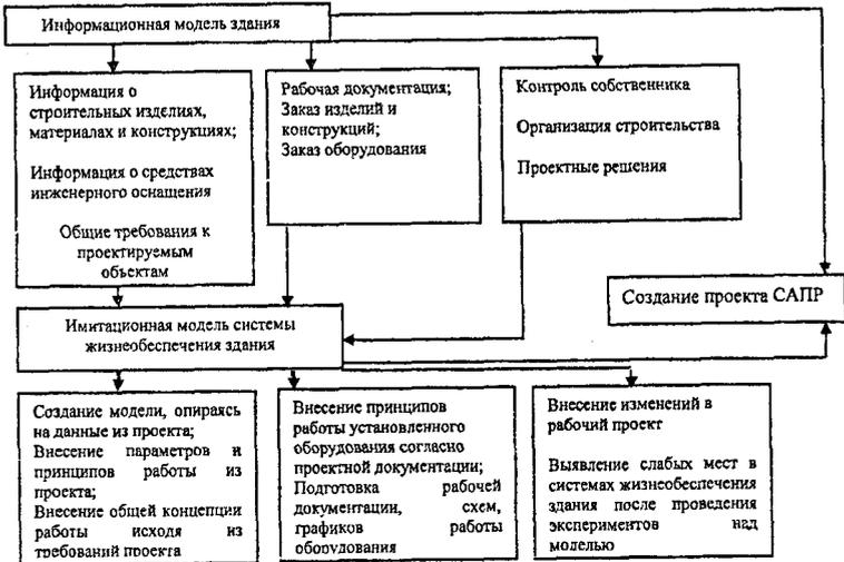
Рис. 19. Взаимодействие информационной модели здания с имитационным моделированием
