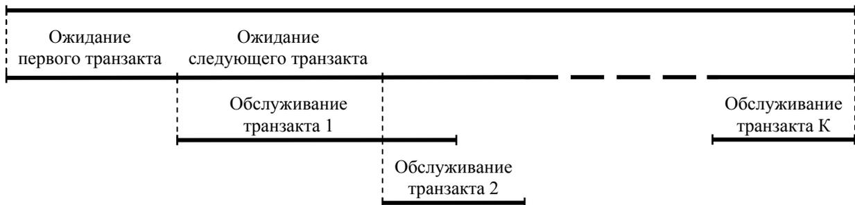
Рис. 5. Временная диаграмма процесса имитационного моделирования
