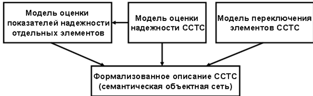
Рисунок 7. Структура комплексной модели ССТС
