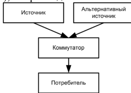
Рисунок 3. Резервная связь через коммутатор
