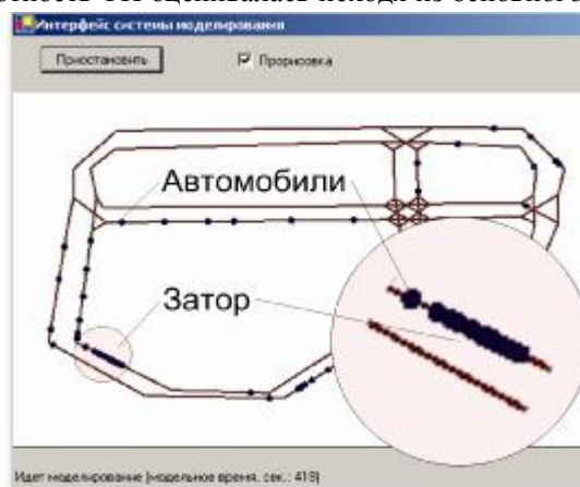
Р и с. 12. Граф УДС тестовой модели. Образование затора
