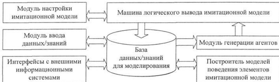
Рисунок 11 – Структура системы моделирования
