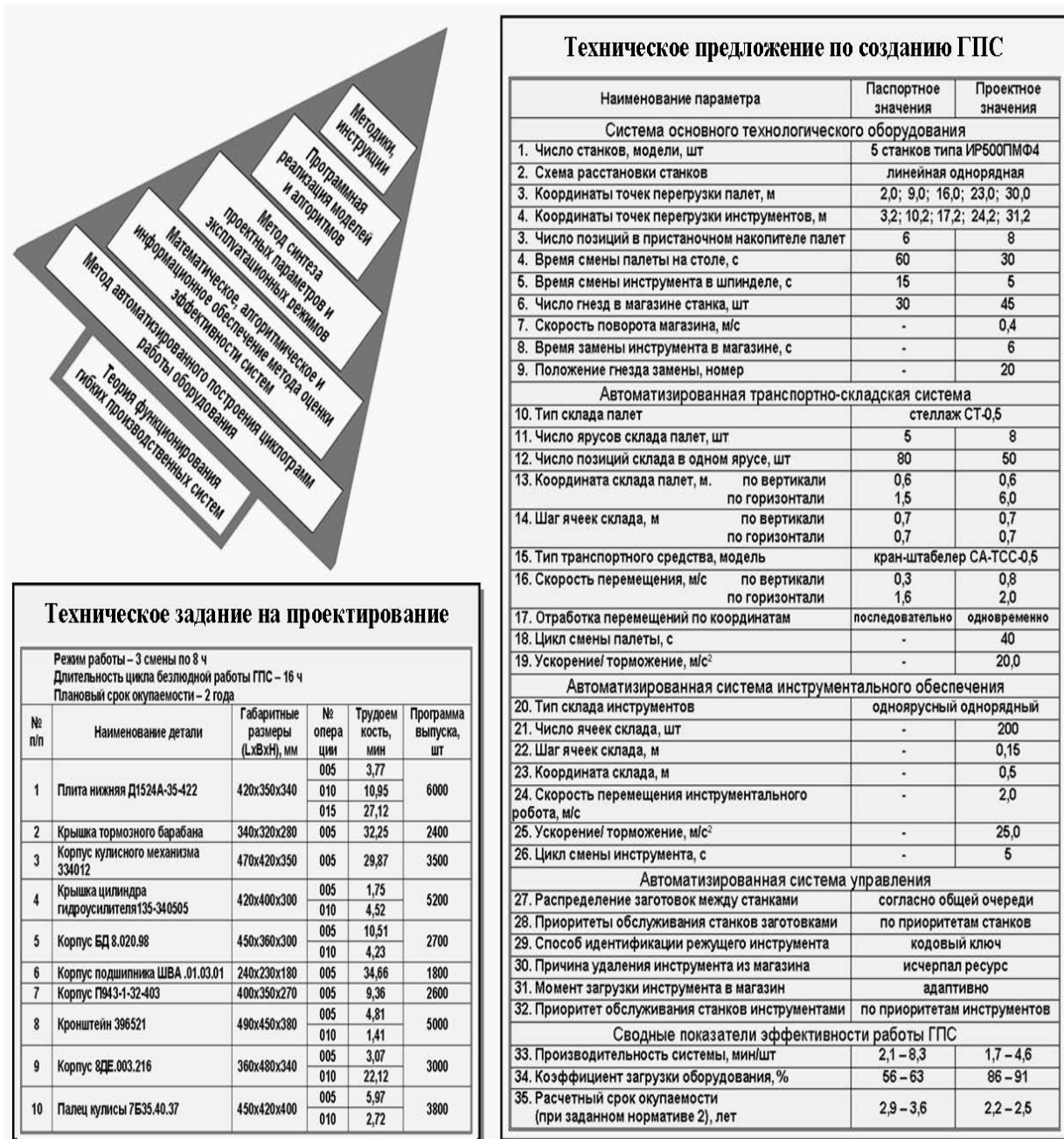
Рисунок 3. Пример содержания технического задания и технического предложения по созданию ГПС
