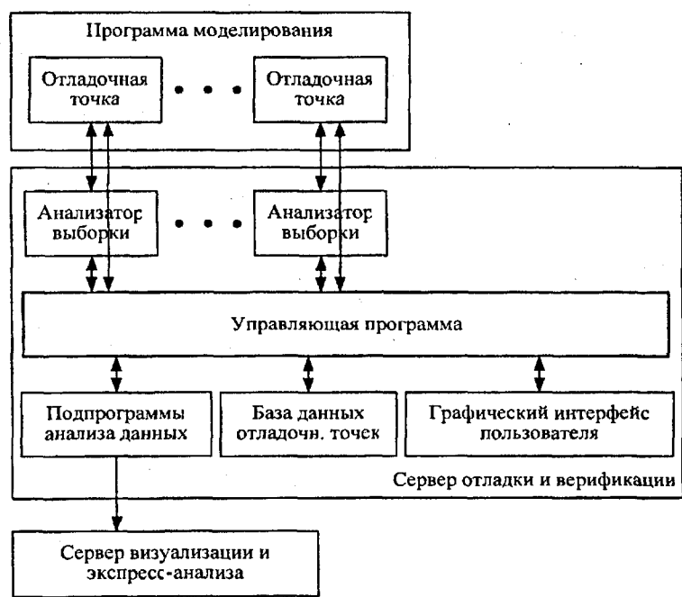
Рис. 8. Архитектура программного обеспечения отладки и верификации алгоритмов ЦОС и программ моделирования
