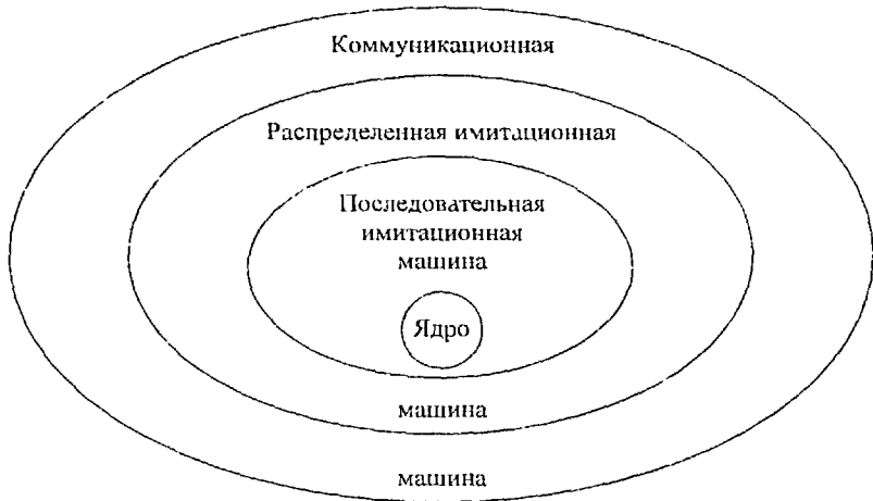
Рис 1. Структура системы распределенного имитационного моделирования Мера .
