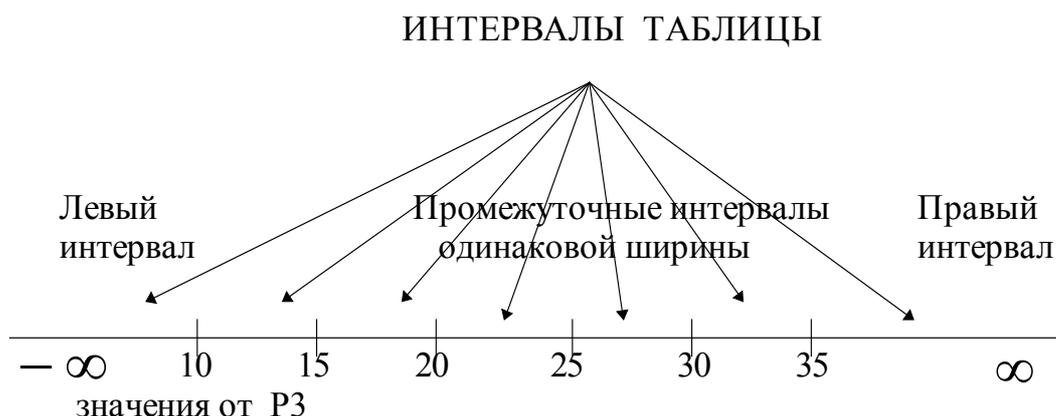
Табулирование требуемой переменной происходит при входе транзакта в блок TABULATE SLU.
