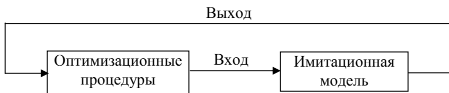
РИС.2. Координация между оптимизатором и имитационной моделью
