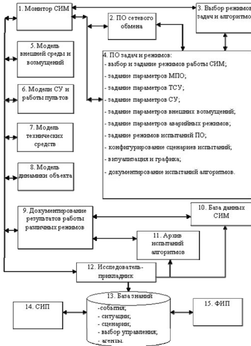
Рис. 5. Функциональная блок-схема программного обеспечения СИМ
