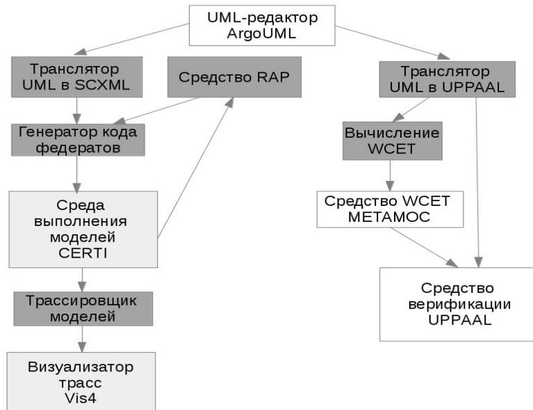
**Рис. 1. Архитектура среды моделирования ДИАНА**
